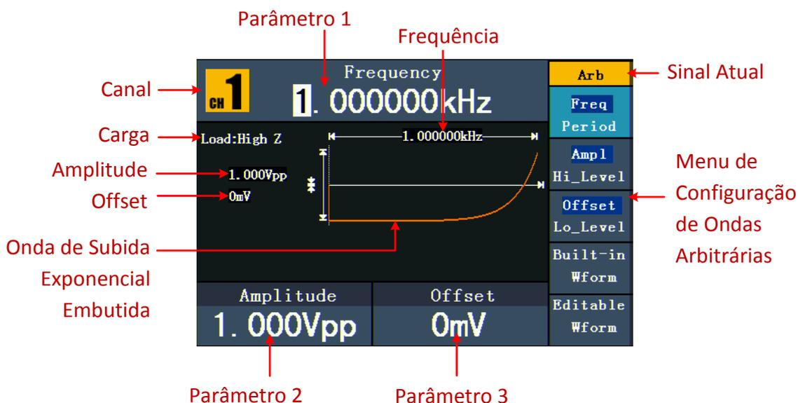
Figura 5-12: Interface de Ondas Arbitrárias
