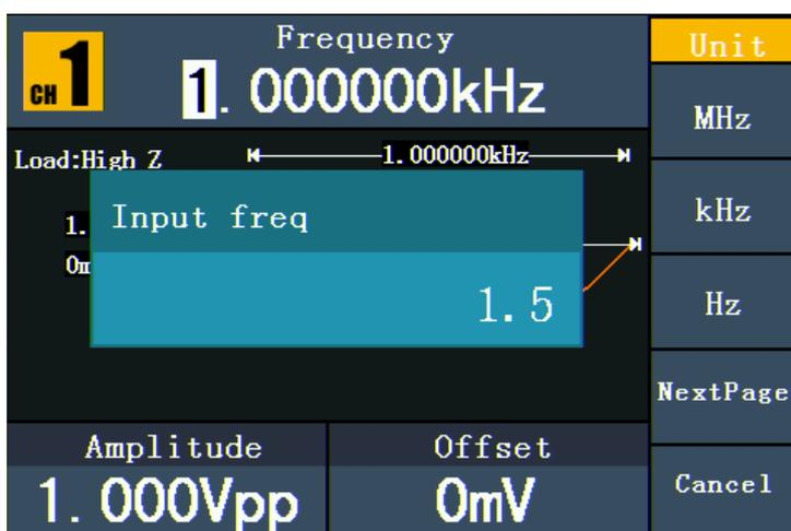
Figura 5-4: Configurar Frequência usando as teclas numéricas.
