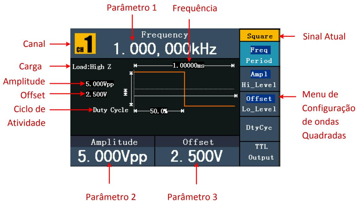
Figura 5-5: Interface dos Sinais de Onda Quadrada
