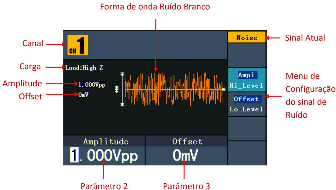
Figura 5-11: Interface da Forma de Onda de Ruído
